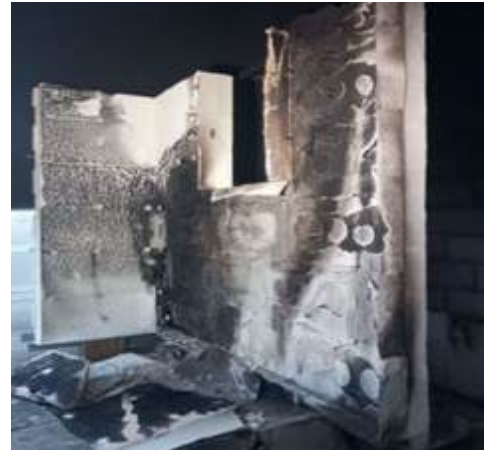
TEST - SISTEMI ETICS CON ISOLANTI CON ISOLANTI COMBUSTIBILI IN EPS
