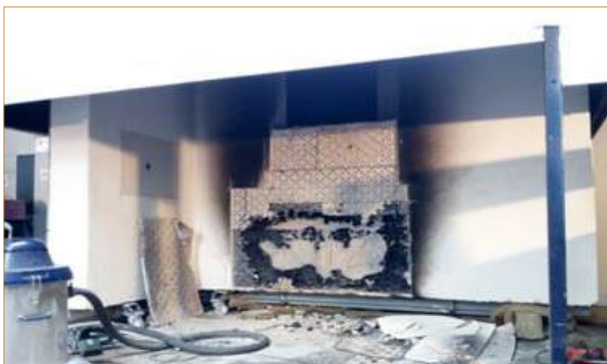
TEST - SISTEMI ETICS CON ISOLANTI CON ISOLANTI COMBUSTIBILI IN EPS + GRAFITE
